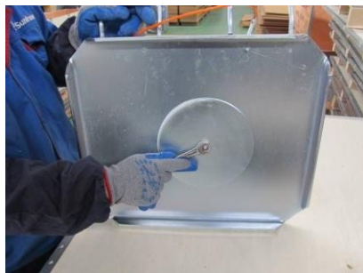
(Demontáž otočného stola s oceleovou doskou) (Vzhľad otočného stola z oceleovej dosky)
