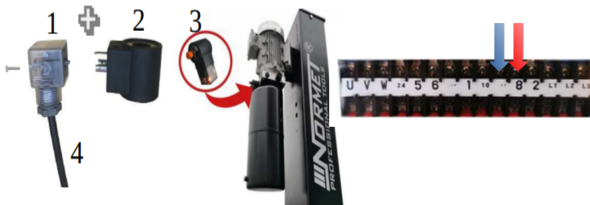
Obr. č. 20 Montáž koncového spínača
