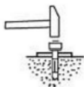
Obr. 16 Montáž kotevných skrutiek
