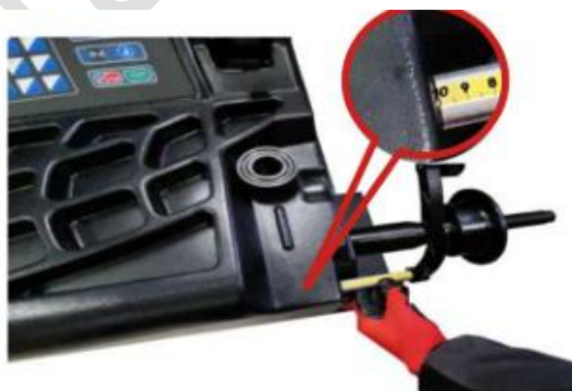
Obr. č. 42. Kalibrácia polohy merania vzdialenosti 100
