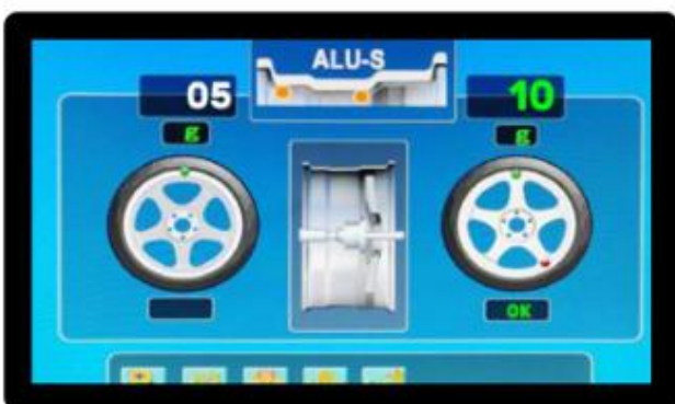
Obr. č. 40. Nalepenie prvého skrytého závažia
