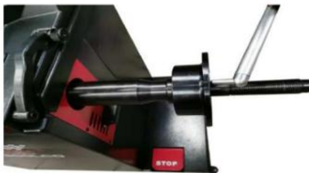
Obr. č. 45. Kalibračná poloha šírkového meradla 0
