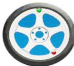
Obr. č. 40. Nalepenie prvého skrytého závažia
