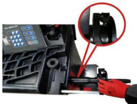
Obr. č. 43. Kalibrácia polohy merania vzdialenosti 0
